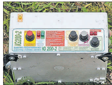
Akun tuottama sähkö johdetaan koekalastuksessa veteen, jolloin kalat tainnutvat hetkeksi.
