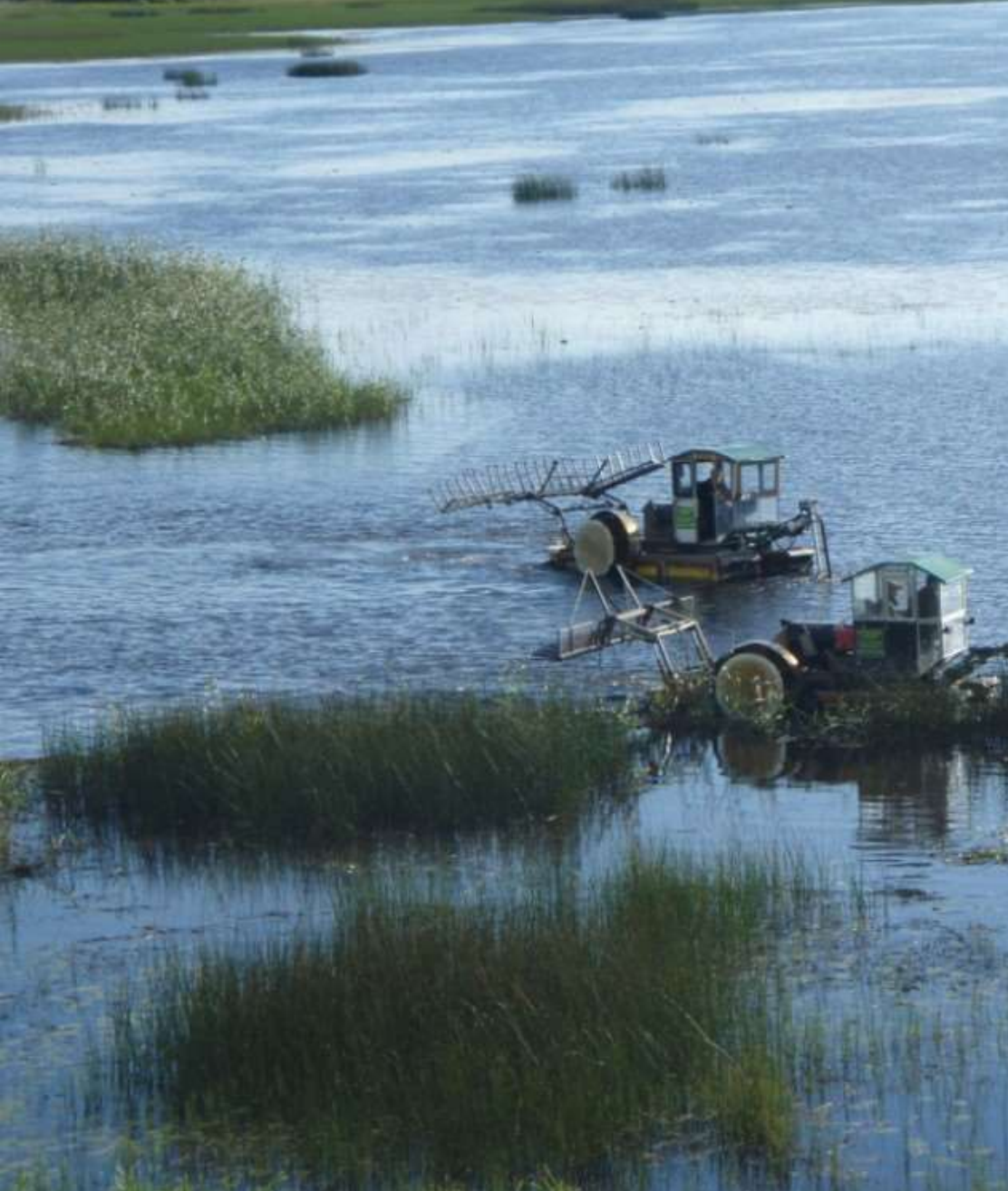
Telavetoinen siipirattailla varustettu Truxor, Kaislapojat/Hämeenlinna
